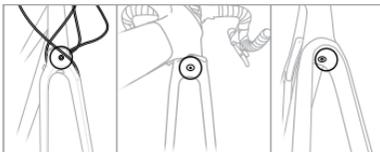
Figura 2.1.1. Ubicación de los tornillos de montaje del guardabarros delantero. I-D: delante, detrás, debajo de la corona.
